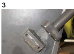
3 Ventil odstranjen NOTE: na Volvo bagrih C serije naša B-Quick spojka se lahko montira direktno - ni vrtnja in navojev
