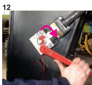
12 Zapiranje B-Quick Obrnite B-Quick ventil v smeri urnega kazalca, da spojko zaprete
